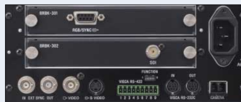
Panel posterior de la unidad multiplexora óptica BRU-300P junto con las tarjetas opcionales BRBK-301 y BRBK-302
