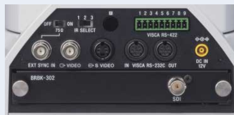
Panel posterior de la cámara BRC-300P junto con la tarjeta SDI BRBK-302
