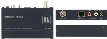
El 711N y el 712N son un transmisor y receptor de par trenzado para señales de video compuesto y audio estéreo desbalanceado. El transmisor 711N convierte la señal de video compuesto y audio estéreo a una señal de par trenzado y el receptor 712N convierte la señal de par trenzado en señales de video compuesto y audio estéreo desbalanceado.
