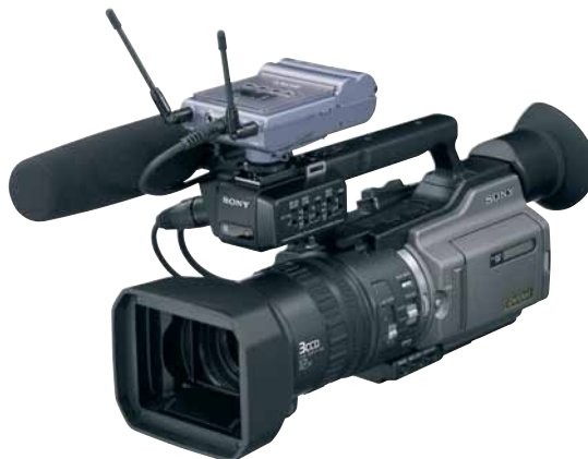
La foto muestra el sistema de microfonía inalámbrica UWP-C1 montado en una DSR-PD170P.
